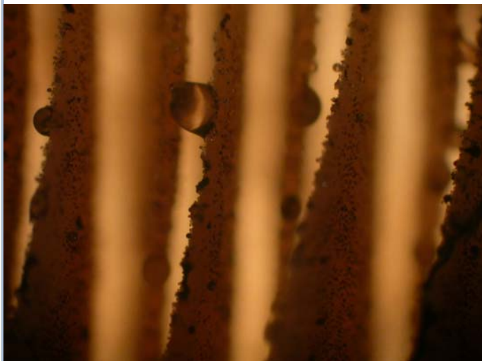
Tränende Lamellen Lamellen
